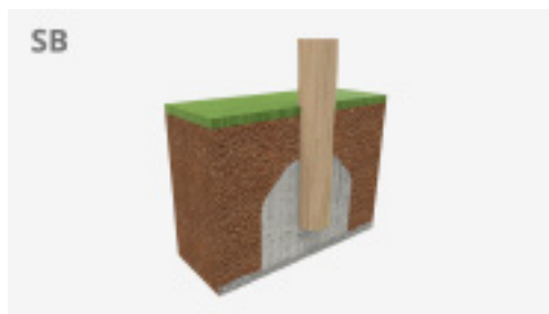
Befestigung eines Holzträgers in einer Rasenfläche
